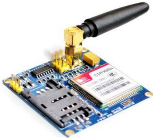
**Figure 4:** SIM900A GSM Module
