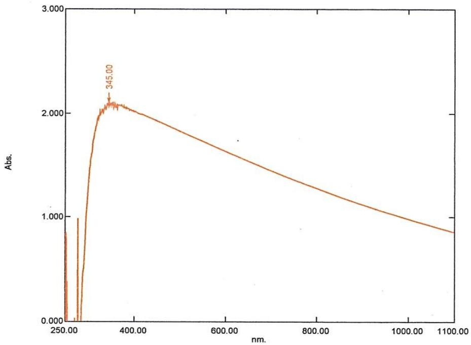
**Figure 3: (d) Sb:SnO<sub>2</sub> 8 mol% (Absorbance)**
