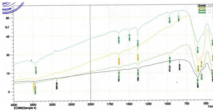
**Figure 20:** FT IR spectra of LaCoFeO<sub>3</sub> nanopowders (a) LaCo<sub>0.6</sub>Fe<sub>0.4</sub>O<sub>3</sub> (b) LaCo<sub>0.7</sub>Fe<sub>0.3</sub>O<sub>3</sub> (c) LaCo<sub>0.8</sub>Fe<sub>0.2</sub>O<sub>3</sub> and (d) LaCo<sub>0.9</sub>Fe<sub>0.1</sub>O<sub>3</sub>
