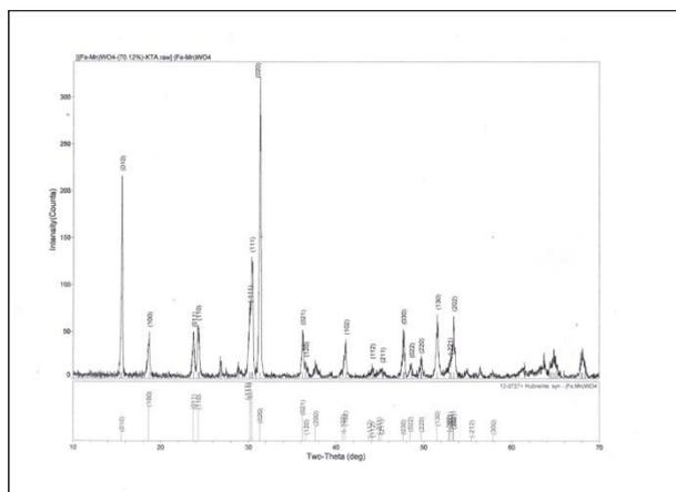
**Figure 1** XRD pattern of wolframite 70%  $(\text{Fe,Mn})\text{WO}_4$
